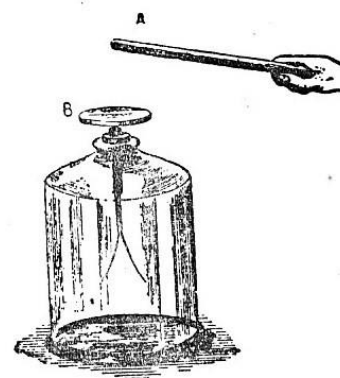
第 13 図 感応によって験電器の箔が開く
